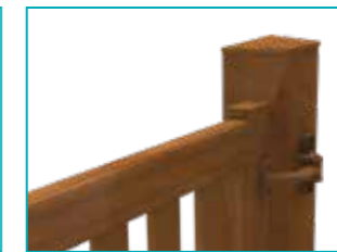
Pose des gonds en applique intérieure, ouverture 180°.
