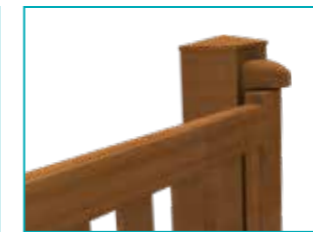
Pose en arrière de pilier, ouverture 180°.
