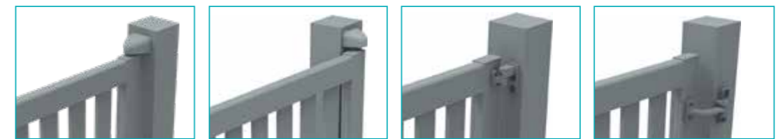
Pose en milieu de pilier, ouverture 90°. Pose en arrière de pilier, ouverture 180°. Pose des gonds en applique intérieure, ouverture à 180°. Pose en applique intérieure, ouverture 120° portail manuel et 105° portail motorisé.
